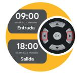
Seleccione entrada (∢) o salida (▶) usando el teclado del dispositivo.
