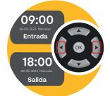
Seleccione entrada (◄) o salida (►) usando el teclado del dispositivo.
